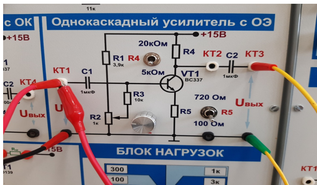
Рис.3 Подключение генератора и каналов осциллографа прибора Velleman к схеме с ОЭ
